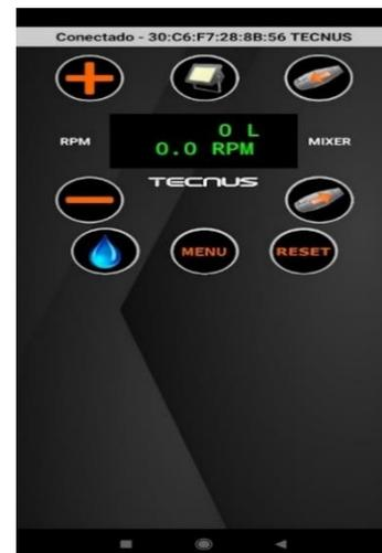
Como se muestra en la aplicación presenta unos botones distintos a los del tablero trasero, pero que realizan las mismas funciones con algunos agregados. La imagen del motor en el centro de los botones “+” y “-” se pondrá de color verde si la conexión es correcta, naranja si se encuentra conectándose o rojo en caso de no poder realizar la conexión.
