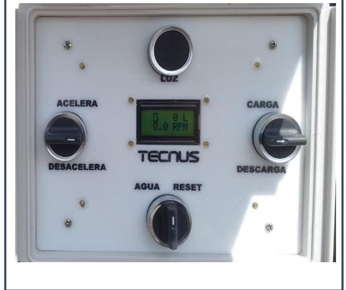
Desde el tablero de comando (**Fig. 13**) ubicado en la parte trasera del chasis se deberá girar/pulsar la perilla/botón (según el tablero que corresponda) del ACELERADOR para llevar la aceleración del camión entre 1500 y 1800 RPM.
